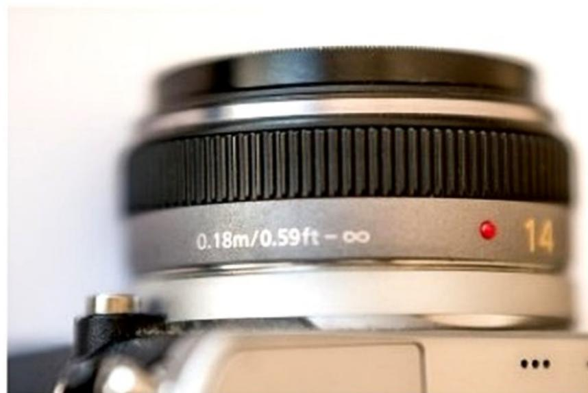
La distance minimale de mise au point est généralement indiquée sur l'objectif, en mètres et en pieds (ft pour « feet »). Ici, le matériel indique 0.18 m, c'est-à-dire 18 cm, ou 0,59 pieds. Attention, cette information correspond à la mesure de la distance entre le sujet net et le capteur, et non entre le sujet net et l'extrémité de l'objectif. Ainsi, lorsque je photographie à distance minimale de mise au point avec cet objectif, 18 cm
